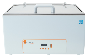
Bac chauffant de 28 litres Puissance 1500W
